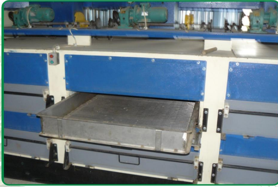
Şekil 18. Elektrik enerjisiyle çalışan kapalı kurutma sistemi
