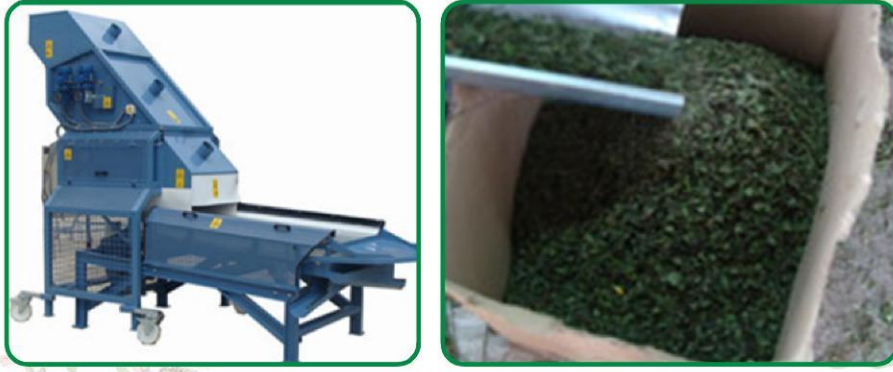
Şekil 20. Kekik ve adaçayı gibi bitkiler için geliştirilmiş harman makinası.
