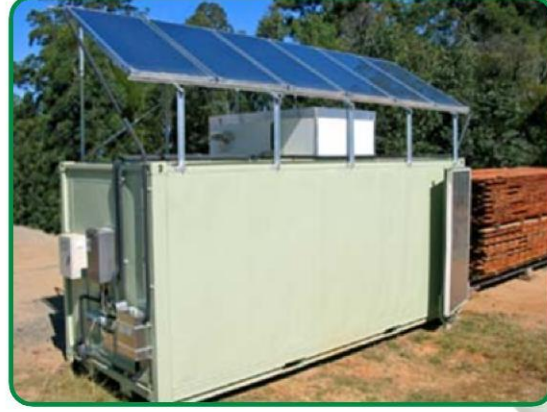
Şekil 17. Güneş enerjisi ile çalışan kapalı kurutma sistemi
